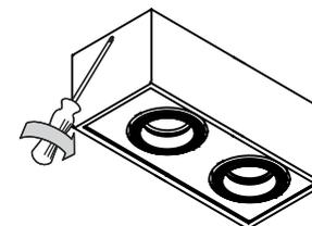
Fixe o corpo colocando de volta os parafusos laterais.
