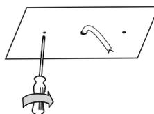
Passe os cabos da rede pelo furo central e parafuse o fundo no teto
